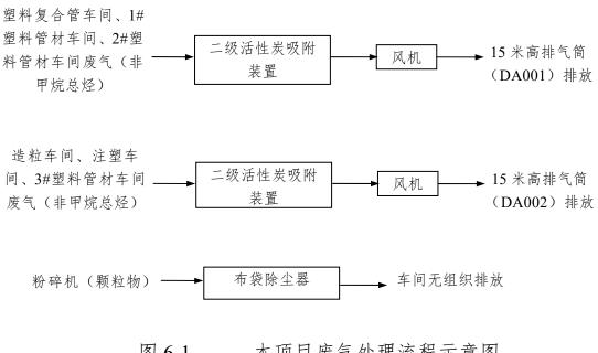
图 6-1 本项目废气处理流程示意图
