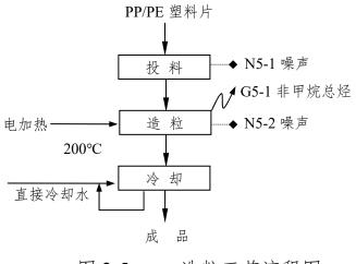
图 2-5 造粒工艺流程图
