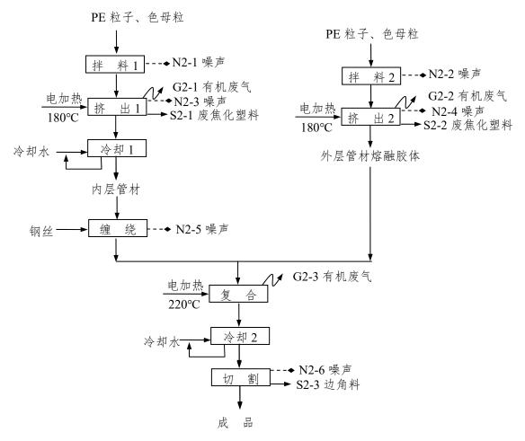
图 2-2 塑料复合管生产工艺流程图
