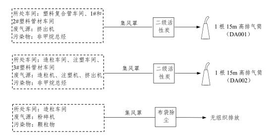
图 3-1 调整后废气收集、处理、排放系统图
